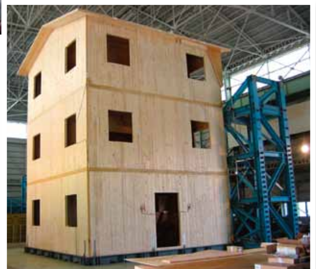
Ett trevåningshus utsätts för vibrationer från en jordbävning som simuleras på ett så kallat skakbord.
